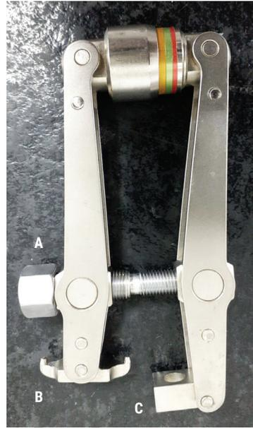
**FIGURA 5:** Compressor removível, onde B representa o "gancho" fixo à placa; C representa o local onde um orifício excêntrico e preso a um parafuso; e A, o parafuso que aproximará B de C, fornecendo compressão. // Fonte: Arquivo de imagem dos autores.
